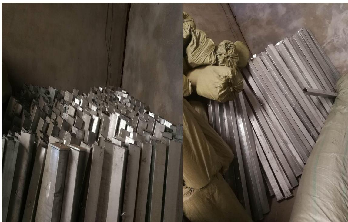
标的五、 $\phi 40$ 柱一批，规格为3.25毫米，1.5m。
